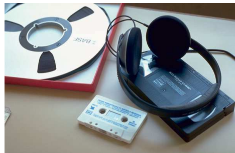
El campo magnético generado por los audífonos provoca alteración de los materiales magnéticos.
